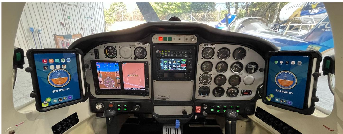
Para que el hardware EFB portátil admita aplicaciones EFB, es posible que se requiera la instalación de al menos algunos componentes, según los requisitos de integridad posicional (por ejemplo, soportes instalados), continuidad de la alimentación y conectividad de datos.
